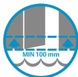
*При монтаже на небольшой высоте (не менее 100 мм) необходимо обеспечить защиту электрозащёлки от загрязнений и воды со стороны пола.*
