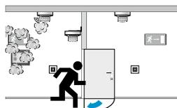
При возникновении пожара магниты отключаются и выходы закрываются.
