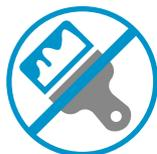
*При проведении малярных работ ни в коем случае не наносить краску или лак на язычок электрозащёлки.*
